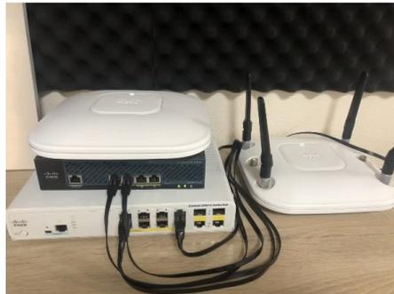
Sur cette topologie on peut voir 1 Switch, UN WLC contrôler et 2 point d'accès (AP pou access Point). On peut voir que les points d'accès ne sont pas alimentés par des alimentations, elles sont alimentés par les câbles Ethernet qui fournissent l'énergie en PoE.
